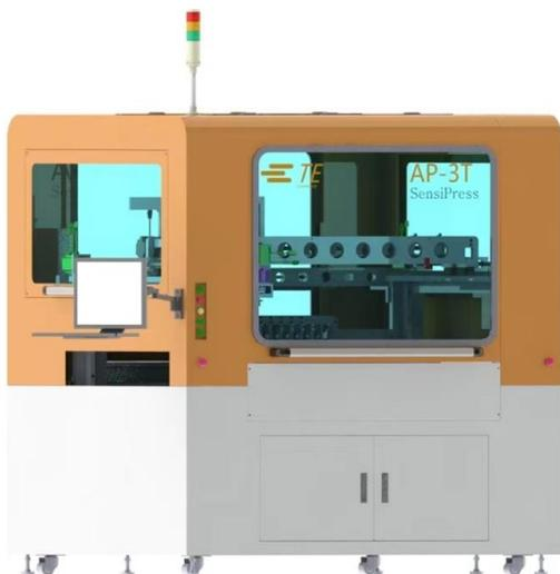
AP-3T/5T 能根据预先编程的压力，高度，和速度要求准确的压接每一个连接器到PCB上。每个连接器的压接都可以单独编程设定参数。连接器的压接程序可以基于压接力或者基于压接的高度设定独立的程序。
