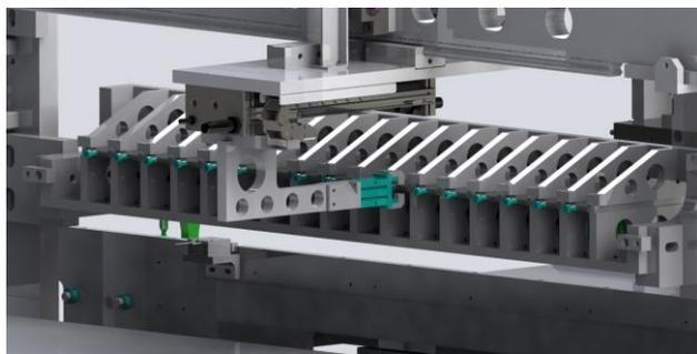
PCB板尺寸最大兼容880 x 760 mm，压接力高达44 KN（5吨），AP-3T/5T压接机专注于小型和大型电路板应用。它还可以容纳多达12套压接工具。
